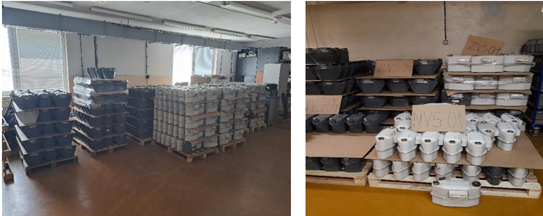
Obr. 14 – Plynomery pripravené na štatistickú kontrolu
