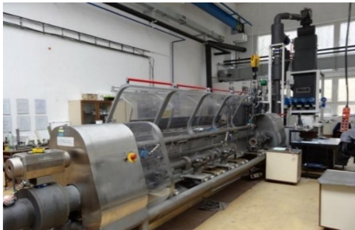
Obr. 10 - Celkový pohľad na národný etalón prietoku a pretečeného množstva vody (NE 021/99)
