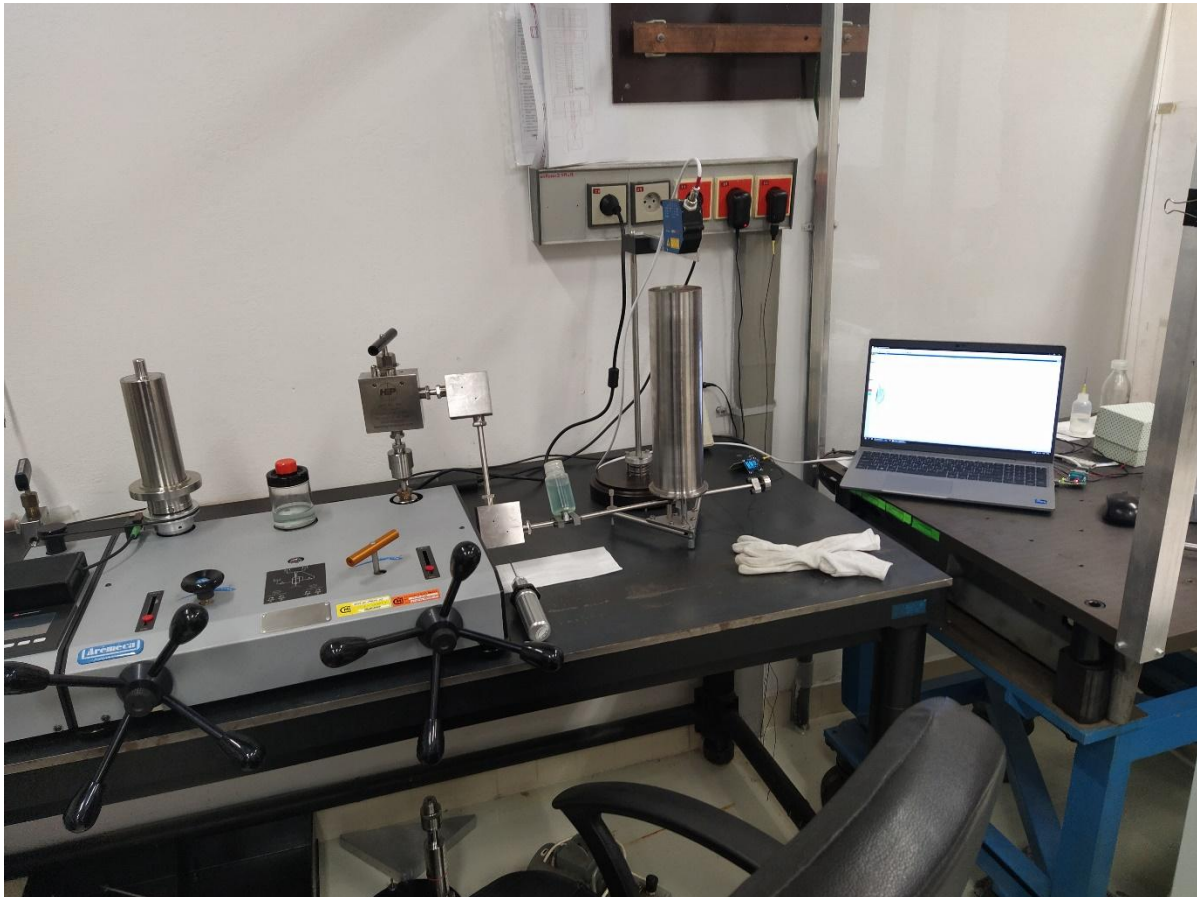
Obr. 6 - Pracovisko pri porovnávacom meraní piestových tlakomerov do 1 GPa.
