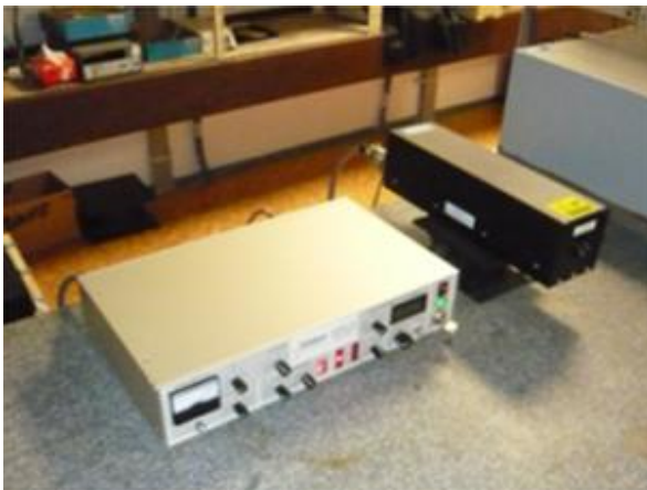
Obr. 3 - Jódom stabilizovaný HeNe laser SMU-1
