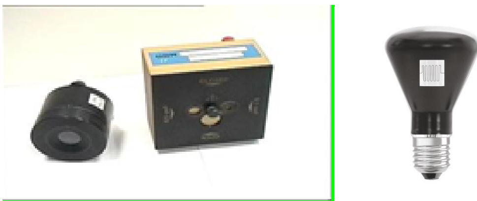
Obr. 26 - Detektory etalónu svietivosti a špeciálna fotometrická lampa
