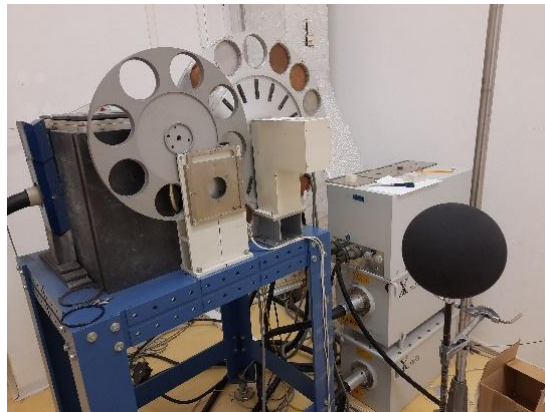
Obr. 1: Ožarovač rtg. spolu so sekundárnou komorou ND1000
