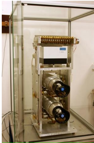
Obr. 16 - Automatický systém na váženie tlakových nádob
