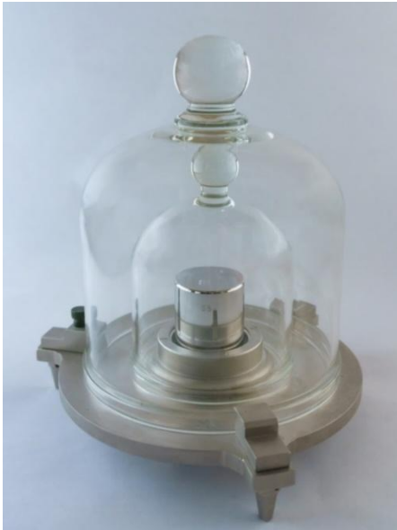
Obr. 4 - Kópia medzinárodného prototypu Ptlr kilogramu č. 65, súčasť NE hmotnosti
