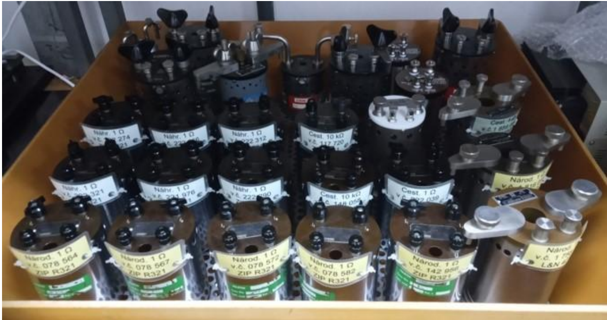
Obr. 21. Zostava národného etalónu elektrického odporu NE 001/97
